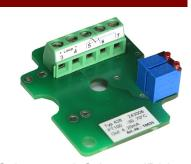
3-Leiterschaltung. Der Messumformer ist nicht vergossen und sollte deshalb nur in Gehäusen mit Schutzart IP64 eingesetzt werden. Auf Wunsch ist auch eine, durch Tauchlack besonders geschützte, Variante lieferbar.
