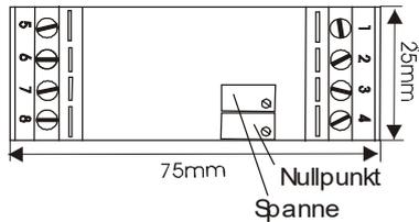
Zum Öffnen der Klarsichthaube muss diese vorsichtig an den schmalen Seiten nach innen gedrückt und abgezogen werden. Die Lage der Regler ist aus dem Bild ersichtlich. Die Regler sind gegen versehentliches Verstellen gesichert. Für geringe Korrekturen kann der Zero-Regler verstellt werden. Der Spanne-Regler sollte möglichst nicht verstellt werden.
